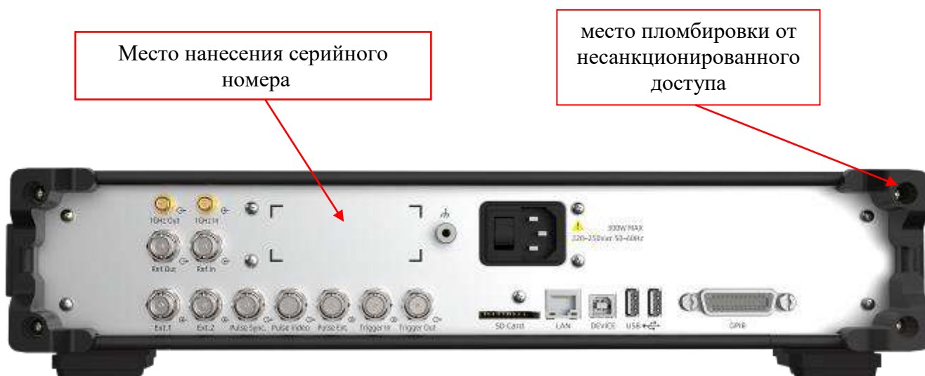
Рисунок 2 – Схема пломбировки от несанкционированного доступа
